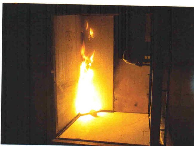
Figura 10: Execução do ensaio pelo método SBI – início
