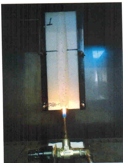
Figura 6: Aplicação do queimador na borda dos corpos de prova.
