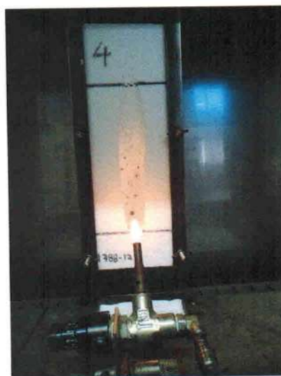
Figura 7: Aplicação do queimador na superfície dos corpos de prova.
