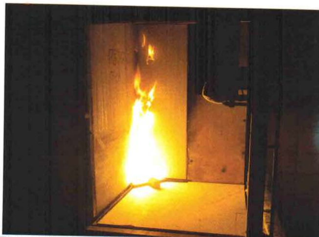
Figura 10: Execução do ensaio pelo método SBI – início
