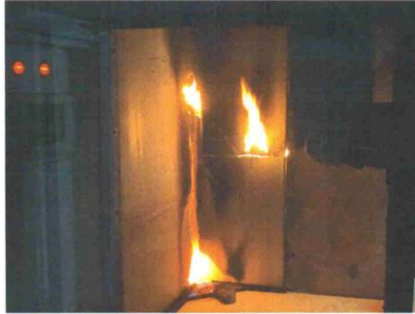
Figura 11: Execução do ensaio pelo método SBI – queima do material do miolo do corpo de prova no final do ensaio
